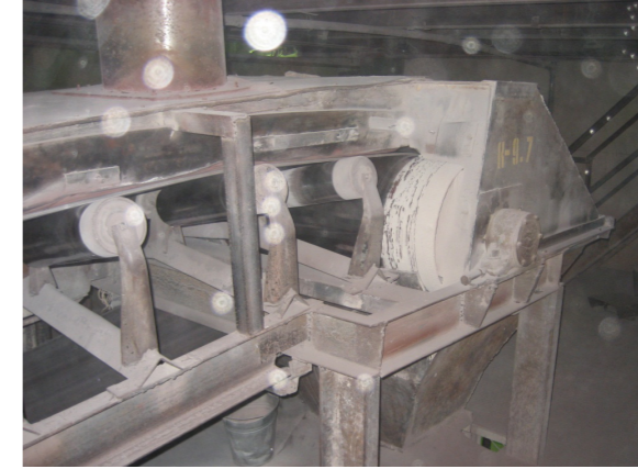
Fotoğraf 1: Döküş noktasında yetersiz filtre uygulaması
