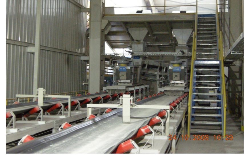
Fotoğraf 8: Aktarım noktasında harman konveyörleri ve toz tutma sistemleri
