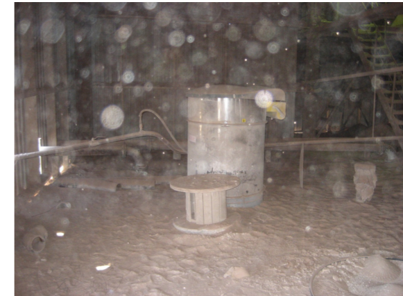
Fotoğraf 2: Silo üstünde yetersiz filtre uygulamasının yol açtığı kirlilik
