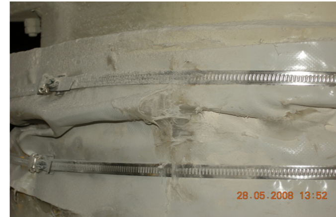
Fotoğraf 6: Yıpranmış bağlantıdan sızan hammadde
